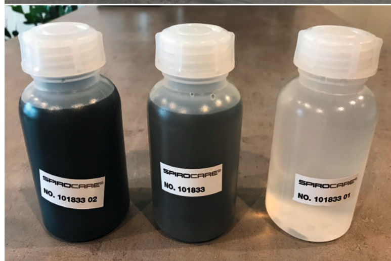
Anlagenwasser vor, während und nach der Aufbereitung
