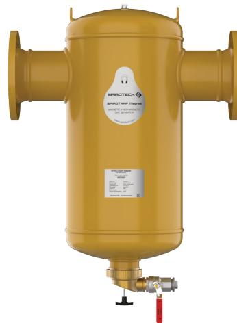
Ein Schlamm- und Magnetitabscheider mit Magnet in Stahl für Standard Durchfluss (1,5 m/s) in DN50 - DN300 Flansch-Ausführung. Ab DN200 mit zwei Magnetstäben.
