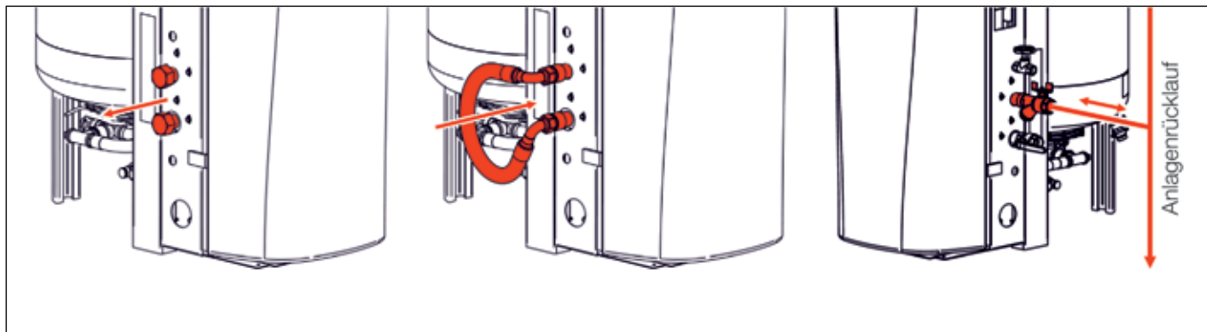
Abbildung 14: Verbindung der Anschlüsse mit dem Bypass-Set und Anschluss an den Anlagenrücklauf
