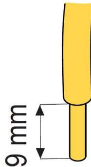
**FIGURE 1, REQUIRED CONNECTION AREA**
